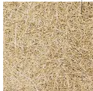
Decke Akustikplatten- Troldekt
